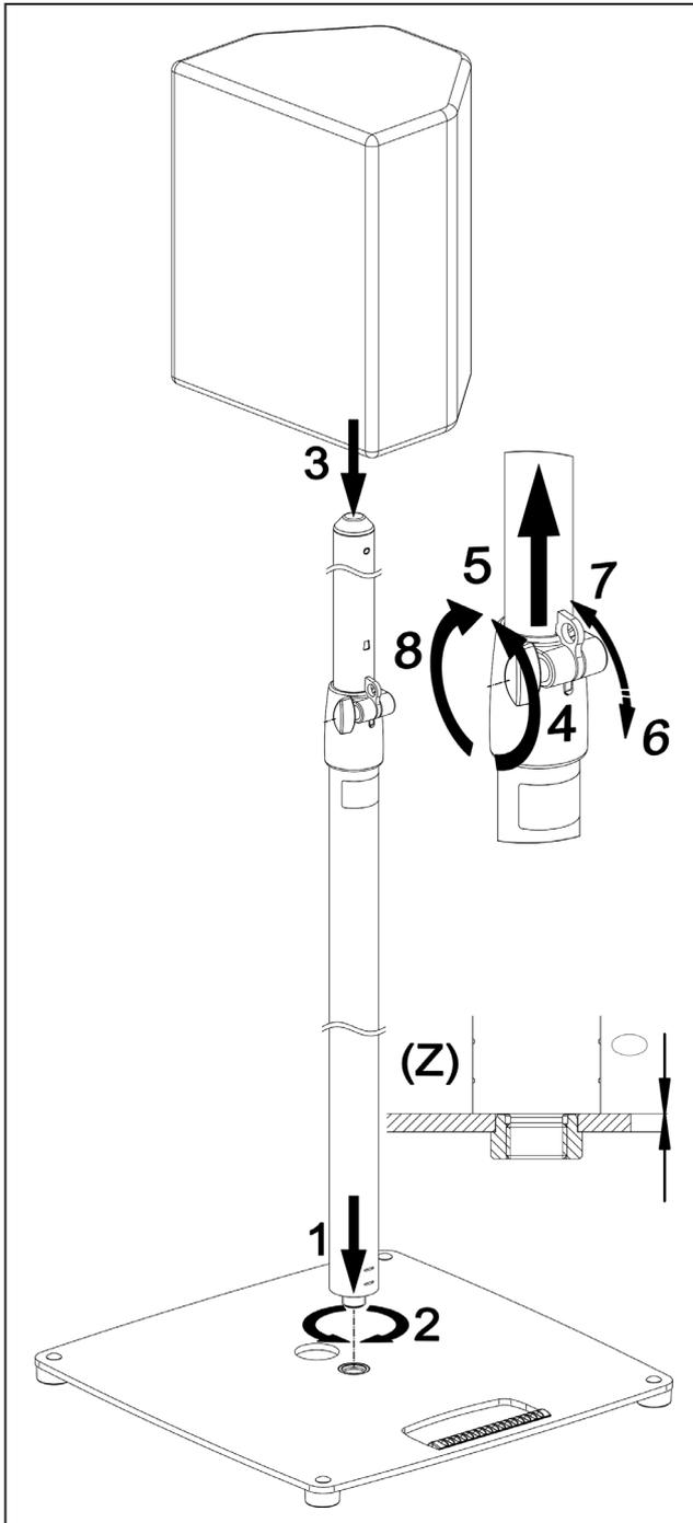
2.) Rohrkombination auf Sockel montieren
