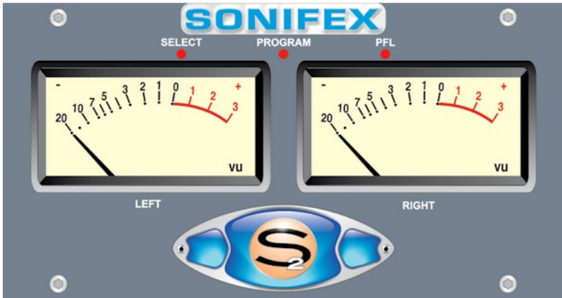
Fig 20-5: VU Meter Panel.
